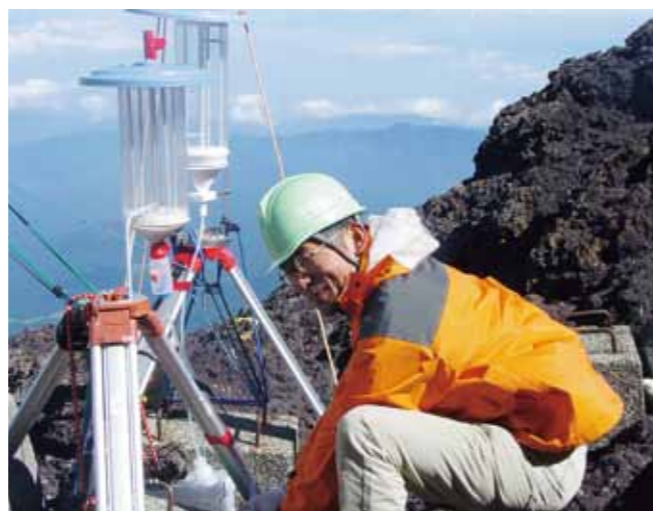
富士山頂に設置した霧粒(雲粒)を採取する装置での作業風景。青いカサの下にある円筒形部分にはテフロン製の細い線が張っており、そこに衝突する水滴が集められるようになっています。
