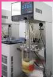
ジャーファーメンター (微生物の培養に用いる装置)
