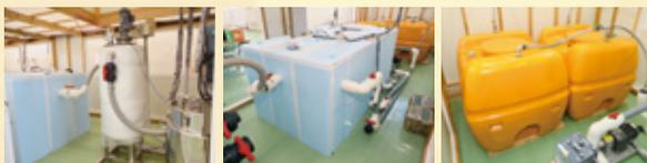
雑草や野菜クズなどを投入すると、メタンガス(=都市ガス)と電気をつくってくれる、今イチオシの実験装置です! 例えば、毎日野菜クズが発生するスーパーマーケットにおくと、そこはエネルギー工場に早変わり! また、たとえ停電を伴う災害が発生しても、雑草をメタン発酵装置に投入すれば、電気を作ることができます。
